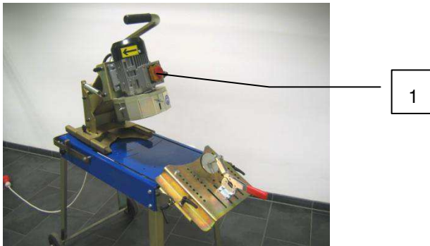
1 Nouzové tlačítko STOP na motoru
